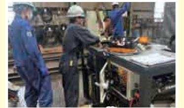
重機の心臓部であるエンジンにトラブルが発生すると、動力となる油圧システムが作動せず、本体やアームなどを動かすことができなくなってしまいます。そんな時、外部から油圧を供給することで重機を一時的に動かすが、この油圧ユニット。現場のピンチを陰から支えるヒーローのような存在です!
