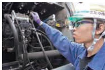
重機の月1回の定期点検と、工事の前夜のメンテナンスなどを担当。エンジンを正常に動かすためのオイルや冷却液の量は適正で濁りなどの異常はないか、緩んでいるネジはないか…一つひとつ目視で確認するほか、運転席に座っての動作確認も実施。作業は一人で行うため重機を現場に送り出してからも気を抜かず、数週間後に何事もなく帰ってきてくれると「良かった」と心からホッとしますね。
